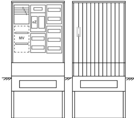
Zähleranschlussssäule für den Außenbereich mit Regendach,
