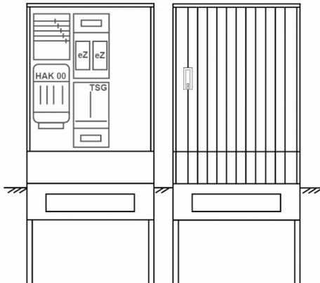
Zähleranschluss säule für den Außenbereich mit Regendach,
