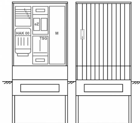
Zähleranschlussssäule für den Außenbereich mit Regendach,
