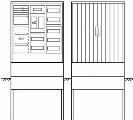
Zähleranschlussssäule für den Außenbereich mit Regendach,
