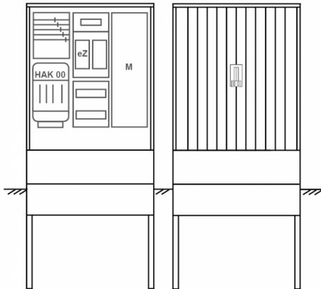
Zähleranschluss säule für den Außenbereich mit Regendach,
