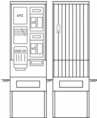
Zähleranschluss säule für den Außenbereich mit Regendach,
