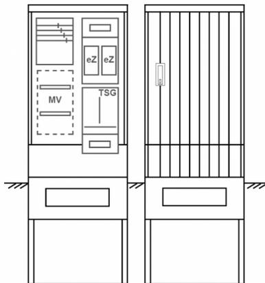
Zähleranschlussssäule für den Außenbereich mit Regendach,
