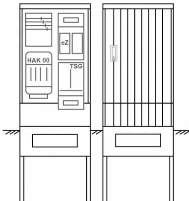
Zähleranschlussssäule für den Außenbereich mit Regendach,
