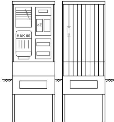
Zähleranschluss säule für den Außenbereich mit Regendach,
