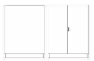
L-SVK6-12-600Leergehäuse Standverteilung, SVK, BxHxT = 1570x1870+130x600Schutzklasse II, IP54, RAL 7035Bestehend aus:Gehäuse, Sockel, Doppeltür mit Schwenkhebel für PHZ, Wandhalterung, ohne Flansche
