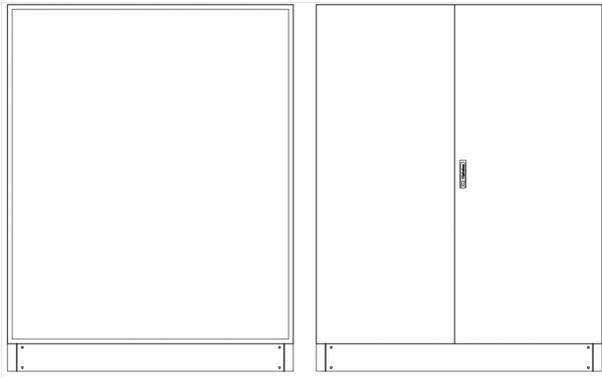
L-SVK6-12-500 Leergehäuse Standverteilung, SVK, BxHxT = 1570x1870+130x500 Schutzklasse II, IP54, RAL 7035 Bestehend aus: Gehäuse, Sockel, Doppeltür mit Schwenkhebel für PHZ, Wandhalterung, ohne Flansche
