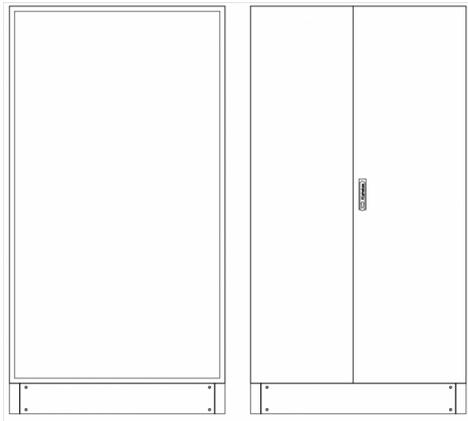
L-SVK4-12-300 Leergehäuse Standverteilung, SVK, BxHxT = 1070x1870+130x300 Schutzklasse II, IP54, RAL 7035 Bestehend aus: Gehäuse, Sockel, Doppeltür mit Schwenkhebel für PHZ, Wandhalterung, ohne Flansche
