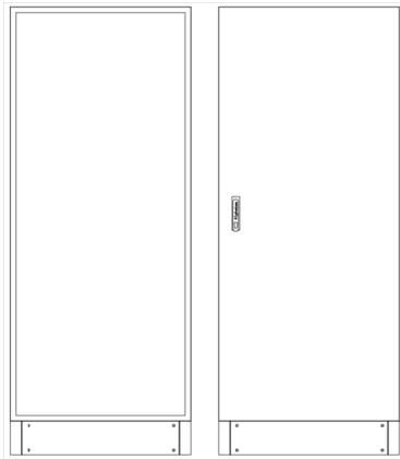
L-SVK3-12-500 Leergehäuse Standverteilung, SVK, BxHxT = 820x1870+130x500 Schutzklasse II, IP54, RAL 7035 Bestehend aus: Gehäuse, Sockel, Einzeltür mit Schwenkhebel für PHZ, Wandhalterung, ohne Flansche
