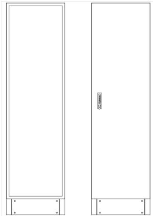
L-SVK2-12-500 Leergehäuse Standverteilung, SVK, BxHxT = 570x1870+130x500 Schutzklasse II, IP54, RAL 7035 Bestehend aus: Gehäuse, Sockel, Einzeltür mit Schwenkhebel für PHZ, Wandhalterung, ohne Flansche
