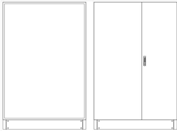
L-SVB5-12-300 Leergehäuse Standverteilung, SVB, BxHxT = 1320x1870+130x300 Schutzklasse I, IP54, RAL 7035 Bestehend aus: Gehäuse, Sockel, Doppeltür mit Schwenkhebel für PHZ, Wandhalterung, ohne Flansche
