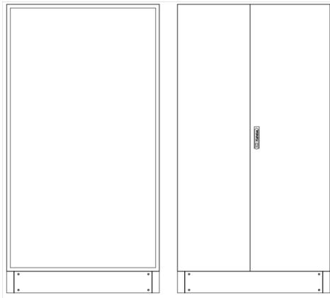
L-SVB4-12-230 Leergehäuse Standverteilung, SVB, BxHxT = 1050x1850+150x230 Schutzklasse I, IP54, RAL 7035 Bestehend aus: Gehäuse, Sockel, Doppeltür mit Schwenkhebel für PHZ, Wandhalterung, ohne Flansche
