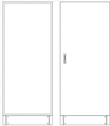
L-SVB3-12-300 Leergehäuse Standverteilung, SVB, BxHxT = 820x1870+130x300 Schutzklasse I, IP54, RAL 7035 Bestehend aus: Gehäuse, Sockel, Einzeltür mit Schwenkhebel für PHZ, Wandhalterung, ohne Flansche
