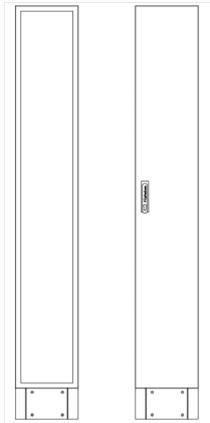
L-SVB1-12-600 Leergehäuse Standverteilung, SVB, BxHxT = 320x1870+130x600 Schutzklasse I, IP54, RAL 7035 Bestehend aus: Gehäuse, Sockel, Einzeltür mit Schwenkhebel für PHZ, Wandhalterung, ohne Flansche
