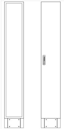
L-SVB1-12-230 Leergehäuse Standverteilung, SVB, BxHxT = 300x1850+150x230 Schutzklasse I, IP54, RAL 7035 Bestehend aus: Gehäuse, Sockel, Einzeltür mit Schwenkhebel für PHZ, Wandhalterung, ohne Flansche
