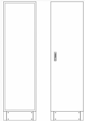
L-RSVK2-12-360 Leergehäuse Reihenschaltschrank, RSVK, BxHxT = 570x1870+130x360 Schutzklasse II, IP54, RAL 7035 offene Seitenwände, Seitenwandprofil gekantet, für Schrankverbindung Bestehend aus: Gehäuse, Sockel, Einzeltür mit Schwenkhebel für PHZ, Wandhalterung, ohne Flansche
