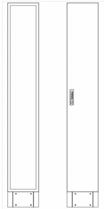
L-RSVK1-12-600 Leergehäuse Reihenschaltschrank, RSVK, BxHxT = 320x1870+130x600 Schutzklasse II, IP54, RAL 7035 offene Seitenwände, Seitenwandprofil gekantet, für Schrankverbindung Bestehend aus: Gehäuse, Sockel, Einzeltür mit Schwenkhebel für PHZ, Wandhalterung, ohne Flansche
