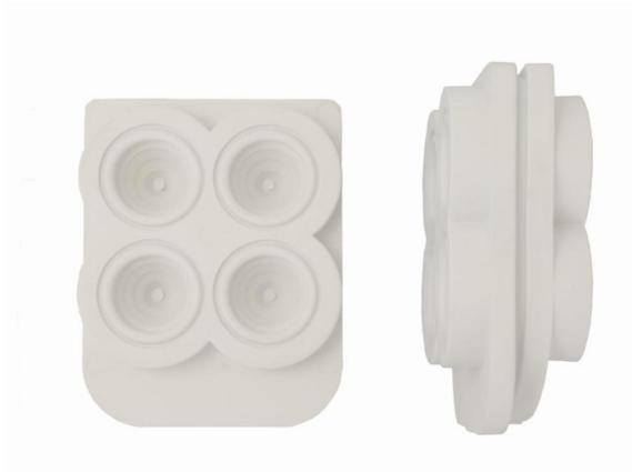
KFL2-4/35 Kabelflansch KFL2-4/35 Schutzart: IP54, Farbe: RAL7035, BxH: 95x120mm Flansch für folgende Kabelquerschnitte: bis 4x Kabel 4x35mm<sup>2</sup> oder 4x Einzelader 1x 300mm<sup>2</sup>
