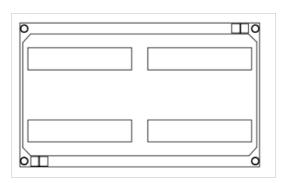
FAO22PS-150Feldabdeckung PS 500x300 offenPolystyrol, RAL 7035Schlitzmaß: 46x216Reihenabstand: 150Bestehend aus:1x Feldabdeckung, 4x Vierteldrehverschluss
