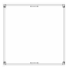
FAG35PRLFeldabdeckung PRL 750x750 geschlossenPolystyrol, RAL 7035, wendbarBestehend aus:1x Feldabdeckung, 2x Haltegriff, 4x Vierteldrehverschluss
