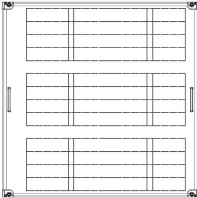
FAG35PRL-SL Feldabdeckung PRL 750x750 mit Stanzungen zum Ausschneiden für Schalleisten Jean Müller und Pronotec, RAL 7035, Bestehend aus: 1x Feldabdeckung, 2x Haltegriff, 4x Vierteldrehverschluss
