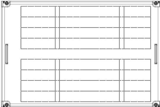
FAG25PRL-SL Feldabdeckung PRL 500x750 mit Stanzungen zum Ausschneiden für Schaltleisten Jean Müller und Pronutec, RAL 7035, Bestehend aus: 1x Feldabdeckung, 2x Haltegriff, 4x Vierteldrehverschluss
