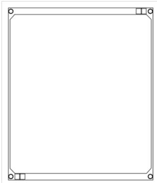
FAG24PS Feldabdeckung PS 500x600 geschlossen Polystyrol, RAL 7035 Bestehend aus: 1x Feldabdeckung, 4x Vierteldrehverschluss
