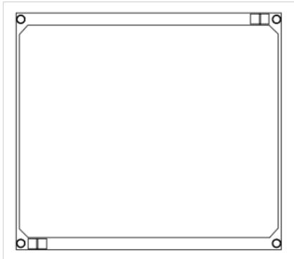
FAG23PS Feldabdeckung PS 500x450 geschlossen Polystyrol, RAL 7035 Bestehend aus: 1x Feldabdeckung, 4x Vierteldrehverschluss
