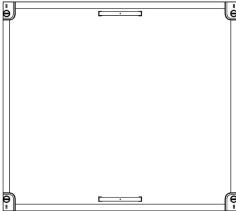
FAG23PRL Feldabdeckung PRL 500x450 geschlossen Polystyrol, RAL 7035,
