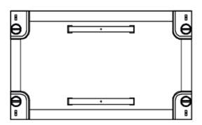
FAG11PRLFeldabdeckung PRL 250x150 geschlossenPolystyrol, RAL 7035, wendbarBestehend aus:1x Feldabdeckung, 1x Haltegriff, 4x Vierteldrehverschluss
