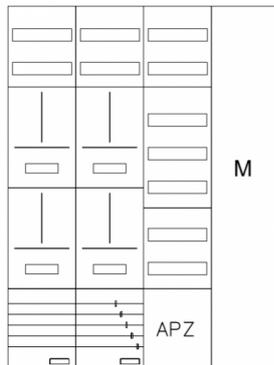
AZ82HS2AM2-210, Zählerverteilung mit 3-Punktbefestigung nach VDE 0603, DIN43870, AR-N 4101:2015 für den Innenbereich für Wandbefestigung AP/UP, Fabr. Alphatec, BxHxT [mm] = 1050x1400x210, Schutzklasse II, IP41, RAL 9016, Bestehend aus: Gehäuse, Einzel- bzw. Doppeltür mit Drehriegel, Flansche NF1 (oben) und NF2 (unten) und Berührungsschutzabdeckungen, aufgebaut wie folgt: 4xZählerplatz, Verteilerfeld (12TE), APZ in Verteilerfeld, Medienfeld, komplett zusammengebaut und verdrahtet gemäß VNB.0070
