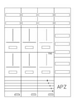
AZ82HS2A-230, Zählerverteilung mit 3-Punktnach VDE 0603, DIN43870, AR-N 4101:2015 für den Innenbereich für Wandbefestigung AP/UP, Fabr. Alphatec, BxHxT [mm] = 1050x1400x230, Schutzklasse II, IP54, RAL 7035, Bestehend aus: Gehäuse, Einzel- bzw. Doppeltür mit Drehriegel, Flansche SF45 (oben) und SF41 (unten) und Berührungsschutzabdeckungen, aufgebaut wie folgt: 5xZählerplatz, TSG, Verteilerfeld (12TE), APZ in Verteilerfeld, komplett zusammengebaut und verdrahtet gemäß VNB.0189
