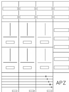
AZ82HS2A-230-6, Zählerverteilung mit 3-Punktnach VDE 0603, DIN43870, AR-N 4101:2015 für den Innenbereich für Wandbefestigung AP/UP, Fabr. Alphatec, BxHxT [mm] = 1050x1400x230, Schutzklasse II, IP54, RAL 7035, Bestehend aus: Gehäuse, Einzel- bzw. Doppeltür mit Drehriegel, Flansche SF45 (oben) und SF41 (unten) und Berührungsschutzabdeckungen, aufgebaut wie folgt: 6xZählerplatz, Verteilerfeld (12TE), APZ in Verteilerfeld, komplett zusammengebaut und verdrahtet gemäß VNB.0190
