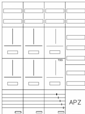
AZ82HS2A-210, Zählerverteilung mit 3-Punktbefestigung nach VDE 0603, DIN43870, AR-N 4101:2015 für den Innenbereich für Wandbefestigung AP/UP, Fabr. Alphatec, BxHxT [mm] = 1050x1400x210, Schutzklasse II, IP41, RAL 9016, Bestehend aus: Gehäuse, Einzel- bzw. Doppeltür mit Drehriegel, Flansche NF1 (oben) und NF2 (unten) und Berührungsschutzabdeckungen, aufgebaut wie folgt: 5xZählerplatz, TSG, Verteilerfeld (12TE), APZ in Verteilerfeld, komplett zusammengesetzt und verdrahtet gemäß VNB.0068
