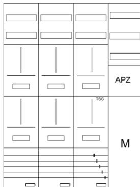
AZ82HS1AM1-210, Zählerverteilung mit 3-Punktbefestigung nach VDE 0603, DIN43870, AR-N 4101:2015 für den Innenbereich für Wandbefestigung AP/UP, Fabr. Alphatec, BxHxT [mm] = 1050x1400x210, Schutzklasse II, IP41, RAL 9016, Bestehend aus: Gehäuse, Einzel- bzw. Doppeltür mit Drehriegel, Flansche NF1 (oben) und NF2 (unten) und Berührungsschutzabdeckungen, aufgebaut wie folgt: 5xZählerplatz, TSG, APZ in Medienfeld, komplett zusammengebaut und verdrahtet gemäß VNB.0066
