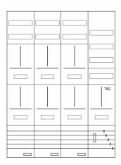
AZ82HS1-230, Zählerverteilung mit 3-Punktnach VDE 0603, DIN43870, AR-N 4101:2015 für den Innenbereich für Wandbefestigung AP/UP, Fabr. Alphatec, BxHxT [mm] = 1050x1400x230, Schutzklasse II, IP54, RAL 7035, Bestehend aus: Gehäuse, Einzel- bzw. Doppeltür mit Drehriegel, Flansche SF45 (oben) und SF41 (unten) und Berührungsschutzabdeckungen, aufgebaut wie folgt: 6xZählerplatz, TSG, Verteilerfeld (12TE), externer APZ erforderlich, komplett zusammengebaut und verdrahtet gemäß VNB.0140
