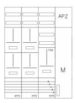
AZ82HM2A-230, Zählerverteilung mit 3-Punktnach VDE 0603, DIN43870, AR-N 4101:2015 für den Innenbereich für Wandbefestigung AP/UP, Fabr. Alphatec, BxHxT [mm] = 1050x1400x230, Schutzklasse II, IP54, RAL 7035, Bestehend aus: Gehäuse, Einzel- bzw. Doppeltür mit Drehriegel, Flansche SF45 (oben) und SF41 (unten) und Berührungsschutzabdeckungen, aufgebaut wie folgt: 4xZählerplatz, TSG, APZ in Medienfeld, komplett zusammengebaut und verdrahtet gemäß VNB.0185
