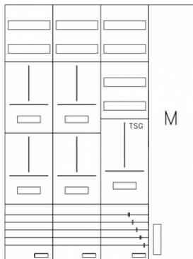
AZ82HM2-230, Zählerverteilung mit 3-Punktnach VDE 0603, DIN43870, AR-N 4101:2015 für den Innenbereich für Wandbefestigung AP/UP, Fabr. Alphatec, BxHxT [mm] = 1050x1400x230, Schutzklasse II, IP54, RAL 7035, Bestehend aus: Gehäuse, Einzel- bzw. Doppeltür mit Drehriegel, Flansche SF45 (oben) und SF41 (unten) und Berührungsschutzabdeckungen, aufgebaut wie folgt: 4xZählerplatz, TSG, Medienfeld, externer APZ erforderlich, komplett zusammengebaut und verdrahtet gemäß VNB.0183
