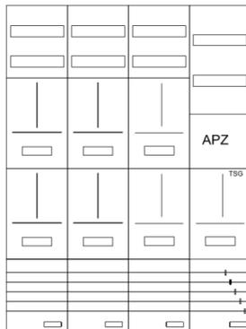
AZ82H1A-210, Zählerverteilung mit 3-Punktbefestigung nach VDE 0603, DIN43870, AR-N 4101:2015 für den Innenbereich für Wandbefestigung AP/UP, Fabr. Alphatec, BxHxT [mm] = 1050x1400x210, Schutzklasse II, IP41, RAL 9016, Bestehend aus: Gehäuse, Einzel- bzw. Doppeltür mit Drehriegel, Flansche NF1 (oben) und NF2 (unten) und Berührungsschutzabdeckungen, aufgebaut wie folgt: 6xZählerplatz, TSG, Verteilerfeld (12TE), APZ in Verteilerfeld, komplett zusammengesetzt und verdrahtet gemäß VNB.0061
