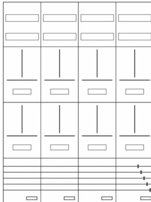
AZ82H-230-8, Zählerverteilung mit 3-Punktnach VDE 0603, DIN43870, AR-N 4101:2015 für den Innenbereich für Wandbefestigung AP/UP, Fabr. Alphatec, BxHxT [mm] = 1050x1400x230, Schutzklasse II, IP54, RAL 7035, Bestehend aus: Gehäuse, Einzel- bzw. Doppeltür mit Drehriegel, Flansche SF45 (oben) und SF41 (unten) und Berührungsschutzabdeckungen, aufgebaut wie folgt: 8xZählerplatz, externer APZ erforderlich, komplett zusammengebaut und verdrahtet gemäß VNB.0139
