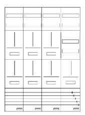
AZ82H-230-2, Zählerverteilung mit 3-Punktnach VDE 0603, DIN43870, AR-N 4101:2015 für den Innenbereich für Wandbefestigung AP/UP, Fabr. Alphatec, BxHxT [mm] = 1050x1400x230, Schutzklasse II, IP54, RAL 7035, Bestehend aus: Gehäuse, Einzel- bzw. Doppeltür mit Drehriegel, Flansche SF45 (oben) und SF41 (unten) und Berührungsschutzabdeckungen, aufgebaut wie folgt: 7xZählerplatz, komplett zusammengebaut und verdrahtet gemäß VNB.0138
