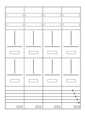
AZ82H-210-8, Zählerverteilung für Zählerplatz mit 3-Punktbefestigung nach VDE 0603, DIN43870, AR-N 4101:2015 für den Innenbereich für Wandbefestigung AP/UP, Fabr. Alphatec, BxHxT [mm] = 1050x1400x210, Schutzklasse II, IP41, RAL 9016, Bestehend aus: Gehäuse, Doppeltür mit Drehriegel, Flansche NF1 (oben) und NF2 (unten) und Berührungsschutzabdeckungen, aufgebaut wie folgt: 8x Zählerplatz, komplett zusammengebaut und verdrahtet gemäß VNB.0001
