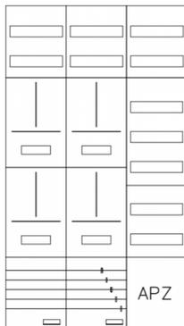
AZ62HS2A-230, Zählerverteilung mit 3-Punktnach VDE 0603, DIN43870, AR-N 4101:2015 für den Innenbereich für Wandbefestigung AP/UP, Fabr. Alphatec, BxHxT [mm] = 800x1400x230, Schutzklasse II, IP54, RAL 7035, Bestehend aus: Gehäuse, Einzel- bzw. Doppeltür mit Drehriegel, Flansche SF45 (oben) und SF41 (unten) und Berührungsschutzabdeckungen, aufgebaut wie folgt: 4xZählerplatz, Verteilerfeld (12TE), APZ in Verteilerfeld, komplett zusammengebaut und verdrahtet gemäß VNB.0181
