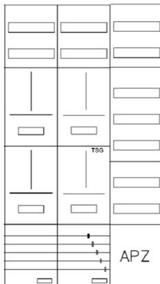
AZ62HS2A-210, Zählerverteilung mit 3-Punktbefestigung nach VDE 0603, DIN43870, AR-N 4101:2015 für den Innenbereich für Wandbefestigung AP/UP, Fabr. Alphatec, BxHxT [mm] = 800x1400x210, Schutzklasse II, IP41, RAL 9016, Bestehend aus: Gehäuse, Einzel- bzw. Doppeltür mit Drehriegel, Flansche NF1 (oben) und NF2 (unten) und Berührungsschutzabdeckungen, aufgebaut wie folgt: 4xZählerplatz, Verteilerfeld (12TE), APZ in Verteilerfeld, komplett zusammengebaut und verdrahtet gemäß VNB.0060
