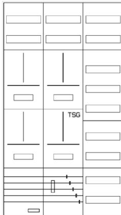
AZ62HS2-230, Zählerverteilung mit 3-Punktnach VDE 0603, DIN43870, AR-N 4101:2015 für den Innenbereich für Wandbefestigung AP/UP, Fabr. Alphatec, BxHxT [mm] = 800x1400x230, Schutzklasse II, IP54, RAL 7035, Bestehend aus: Gehäuse, Einzel- bzw. Doppeltür mit Drehriegel, Flansche SF45 (oben) und SF41 (unten) und Berührungsschutzabdeckungen, aufgebaut wie folgt: 3xZählerplatz, TSG, Verteilerfeld (12TE), externer APZ erforderlich, komplett zusammengebaut und verdrahtet gemäß VNB.0137
