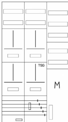
AZ62HS1M1-230, Zählerverteilung mit 3-Punktnach VDE 0603, DIN43870, AR-N 4101:2015 für den Innenbereich für Wandbefestigung AP/UP, Fabr. Alphatec, BxHxT [mm] = 800x1400x230, Schutzklasse II, IP54, RAL 7035, Bestehend aus: Gehäuse, Einzel- bzw. Doppeltür mit Drehriegel, Flansche SF45 (oben) und SF41 (unten) und Berührungsschutzabdeckungen, aufgebaut wie folgt: 3xZählerplatz, TSG, Verteilerfeld (12TE), Medienfeld, externer APZ erforderlich, komplett zusammengebaut und verdrahtet gemäß VNB.0136
