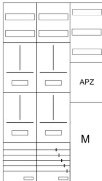
AZ62HS1AM1-230, Zählerverteilung mit 3-Punktnach VDE 0603, DIN43870, AR-N 4101:2015 für den Innenbereich für Wandbefestigung AP/UP, Fabr. Alphatec, BxHxT [mm] = 800x1400x230, Schutzklasse II, IP54, RAL 7035, Bestehend aus: Gehäuse, Einzel- bzw. Doppeltür mit Drehriegel, Flansche SF45 (oben) und SF41 (unten) und Berührungsschutzabdeckungen, aufgebaut wie folgt: 4xZählerplatz, APZ in Medienfeld, komplett zusammengebaut und verdrahtet gemäß VNB.0180
