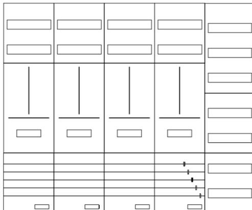
AZ52BS-230-2, Zählerverteilung mit 3-Punktnach VDE 0603, DIN43870, AR-N 4101:2015 für den Innenbereich für Wandbefestigung AP/UP, Fabr. Alphatec, BxHxT [mm] = 1300x1100x230, Schutzklasse II, IP54, RAL 7035, Bestehend aus: Gehäuse, Einzel- bzw. Doppeltür mit Drehriegel, Flansche SF45 (oben) und SF41 (unten) und Berührungsschutzabdeckungen, aufgebaut wie folgt: 4xZählerplatz, Verteilerfeld (12TE), externer APZ erforderlich, komplett zusammengebaut und verdrahtet gemäß VNB.0177
