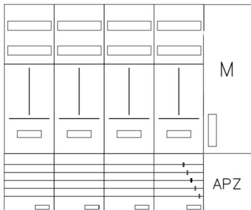
AZ52BMA-230, Zählerverteilung mit 3-Punktnach VDE 0603, DIN43870, AR-N 4101:2015 für den Innenbereich für Wandbefestigung AP/UP, Fabr. Alphatec, BxHxT [mm] = 1300x1100x230, Schutzklasse II, IP54, RAL 7035, Bestehend aus: Gehäuse, Einzel- bzw. Doppeltür mit Drehriegel, Flansche SF45 (oben) und SF41 (unten) und Berührungsschutzabdeckungen, aufgebaut wie folgt: 4xZählerplatz, APZ in Medienfeld, komplett zusammengebaut und verdrahtet gemäß VNB.0176
