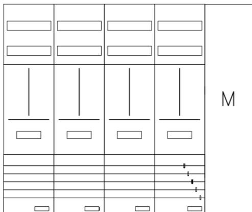
AZ52BM-230, Zählerverteilung mit 3-Punktnach VDE 0603, DIN43870, AR-N 4101:2015 für den Innenbereich für Wandbefestigung AP/UP, Fabr. Alphatec, BxHxT [mm] = 1300x1100x230, Schutzklasse II, IP54, RAL 7035, Bestehend aus: Gehäuse, Einzel- bzw. Doppeltür mit Drehriegel, Flansche SF45 (oben) und SF41 (unten) und Berührungsschutzabdeckungen, aufgebaut wie folgt: 4xZählerplatz, Medienfeld, externer APZ erforderlich, komplett zusammengebaut und verdrahtet gemäß VNB.0175
